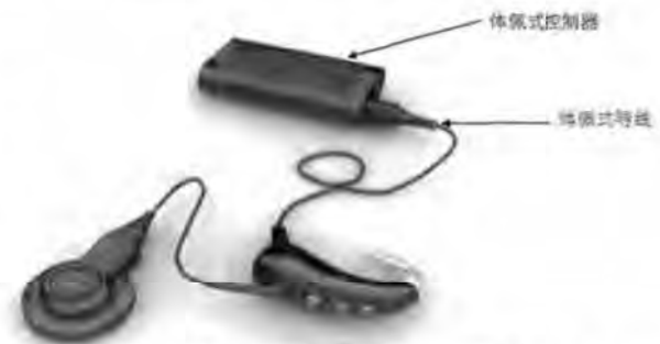
图4 诺尔康-晨星人工耳蜗系统体外部分（体佩式言语处理器）
