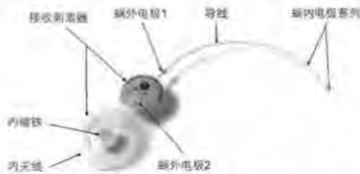
图1 诺尔康-晨星人工耳蜗系统体内部分（植入体）
