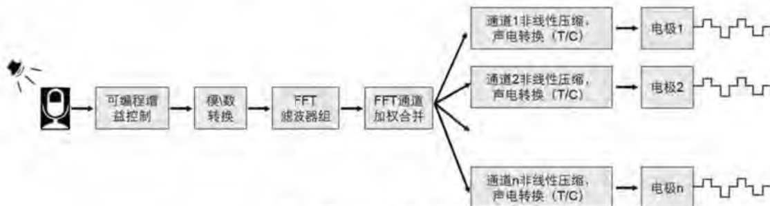
图2 基于FFT滤波器组的实时处理方式
