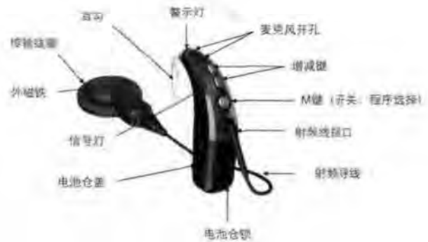
图3 诺尔康-晨星人工耳蜗系统体外部分（耳背式言语处理器）
